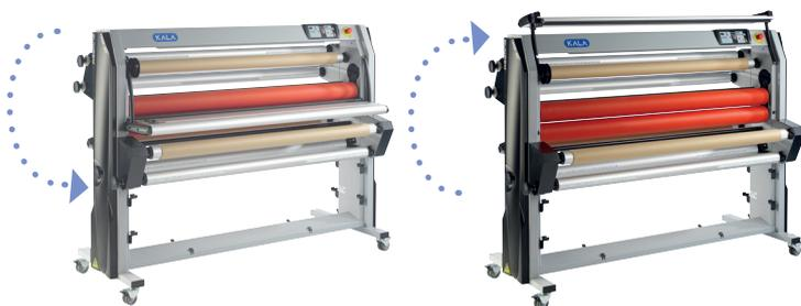
La table d'introduction pivote en position haute, facilitant l'accès aux emplacements des bobines. Table levée, l'avance de la machine ne peut être déclenchée sécurisant l'opérateur durant cette phase.
