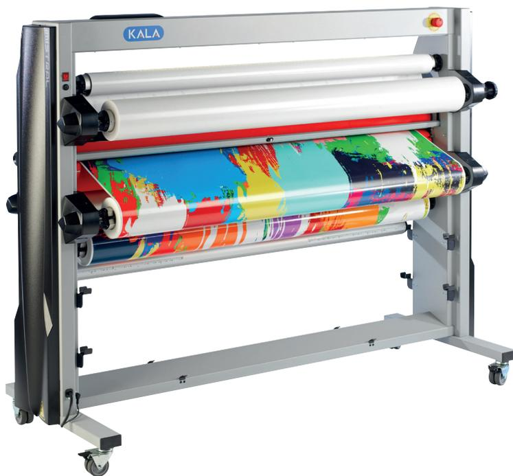
Nos lamineurs permettent de travailler des bobines d'impression complètes jusqu'à 100 mètres de longueur en toute autonomie.
